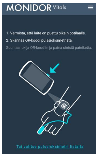
Kuva 2 Langattoman potilasmonitorin yhdistäminen pulssioksimetriin skannaamalla pulssioksimetrin QR-koodi
